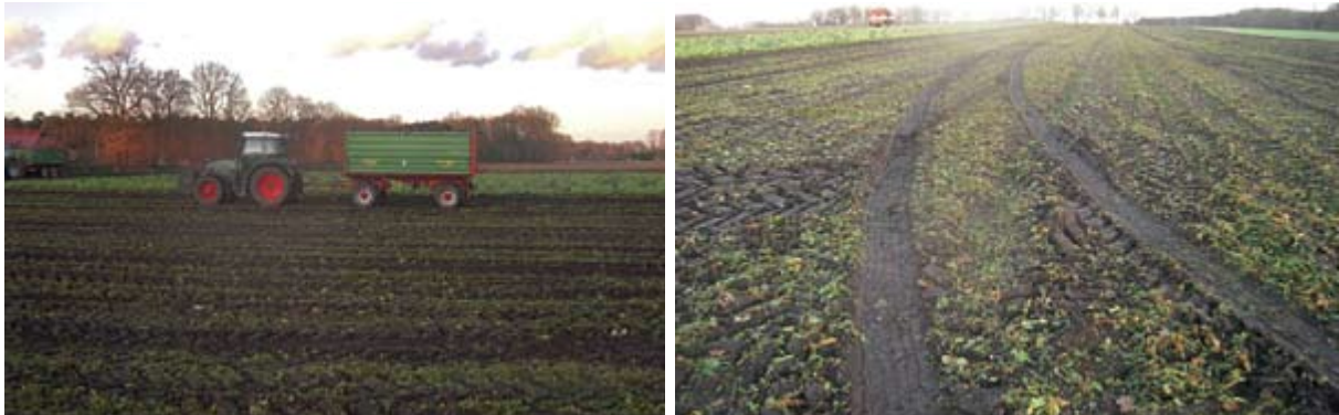
Abbildung 25: Bodenverdichtungen auf dem Acker durch schmale Bereifung (siehe linkes Foto)
