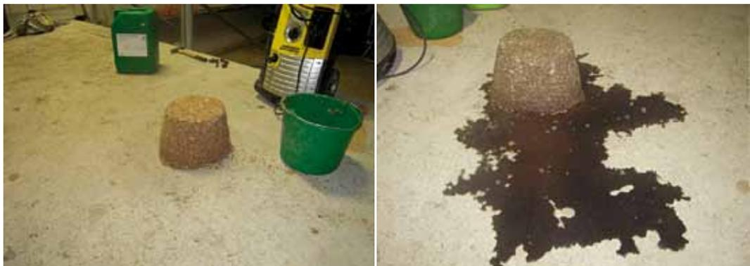
Abbildung 22: Rüben nach Putsch-Zerkleinerer (Zeitabstand 40 Min.)
