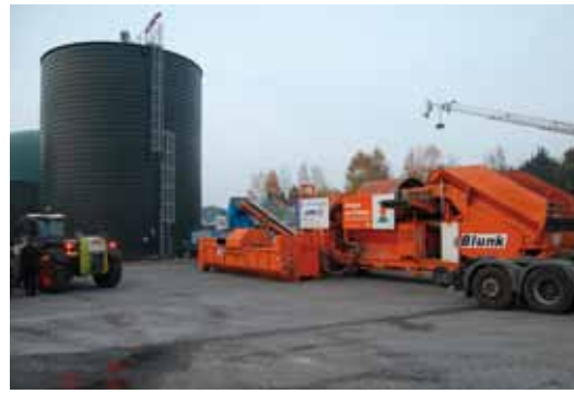
Abb. 10: Blunk-Wäsche mit Steintrennung und Beet-Cruscher (Fa. Putsch) am Standort Messingen mit Hochsilolagerung
