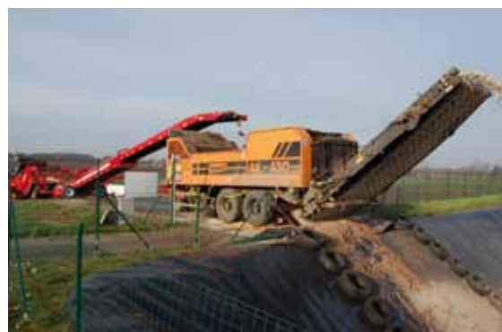
Abb. 14: Transport der Rüben auf dem Beet-Loader (Fa. Grimme) zum Schredder (Fa. Doppstadt) mit direkter Übergabe des Rübenmuses ins Erdbecken
