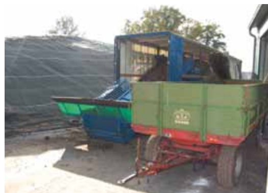
Abb. 11: Einsatz des Rübenetrucks an der flächenmäßig begrenzten Biogasanlage in Sommeringen
